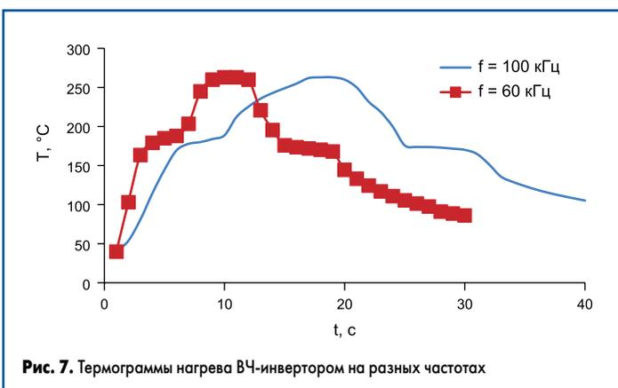
Рис. 7. Термограммы нагрева ВЧ-инвертором на разных частотах
