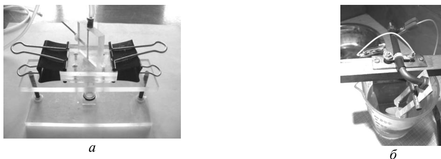
Рис. 1. Электрохимическая ячейка: a — типа O-ring; б — с U-образным катодом
