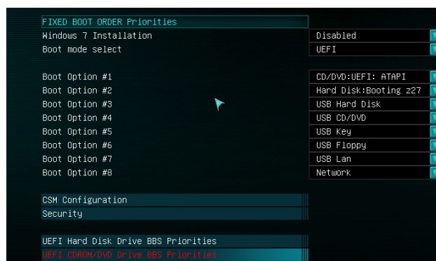
Рисунок 5 — Окно настроек с двумя строками возможных загрузочных разделов EFI
