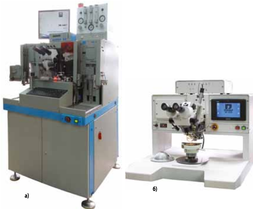
Рис. 7. Автомат присоединения медных выводов ЭМ-4461(а) и полуавтомат ЭМ-4320У(б)
