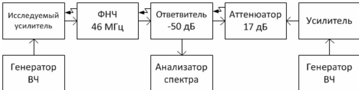
Рис. 3. Схема измерительного стенда.
