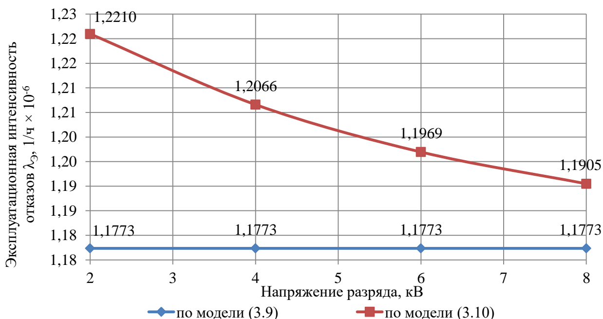
Рис. 1 – График сравнения эксплуатационной интенсивности отказов биполярных цифровых ИС, полученной по моделям (1) и (2) для контактного разряда
