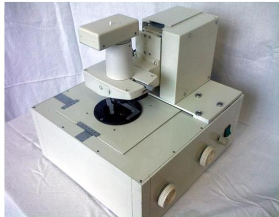
Рис. 2. Двухкоординатный компьютеризированный сканер комплекса «ХРОМОСОМА»
