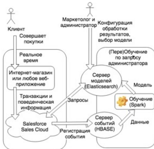
Рис. 2 – Функциональная схема системы
