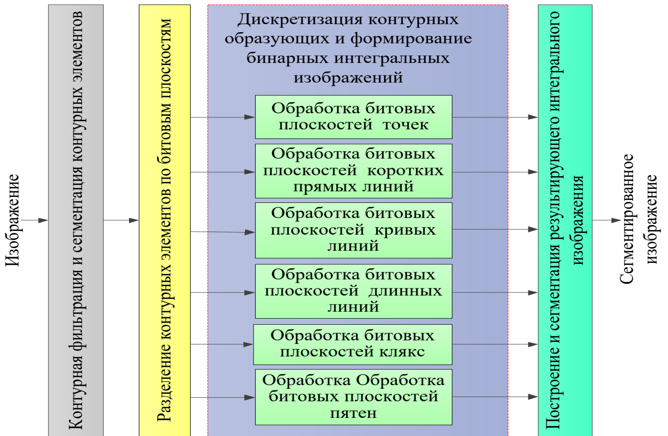
Рисунок 1. – Схема метода текстурной сегментации изображений на основе анализа формы контурных образующих
