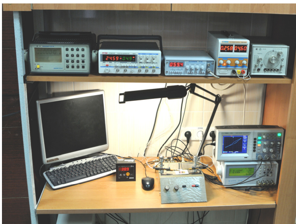
Рисунок 2. – Общий вид диагностического комплекса для анализа диэлектрических свойств тонких пленок
