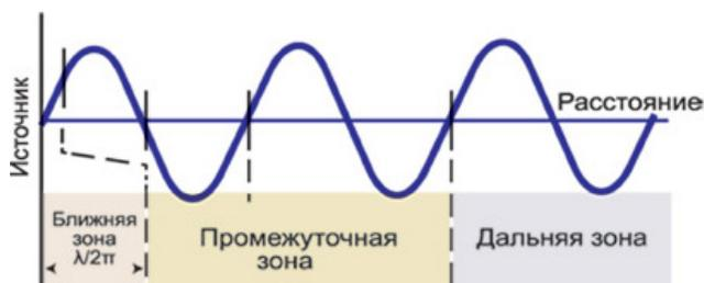
Рисунок 1 – Расположение зон электромагнитного поля
