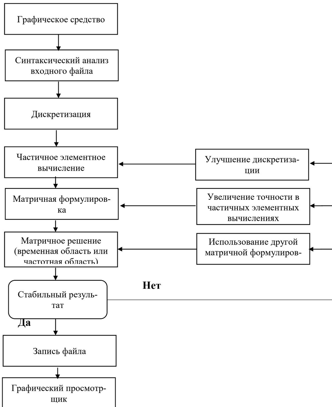
**Рисунок 3 – Алгоритм метода частичных эквивалентных схем элементов**
