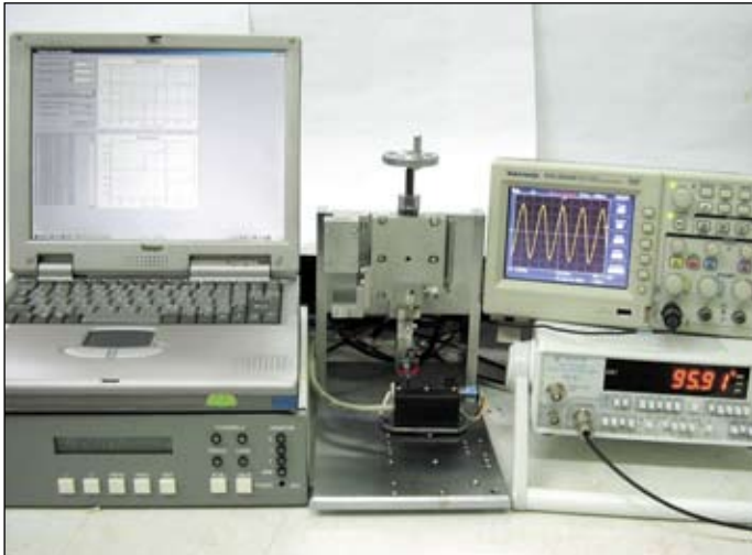
Рис. 7. Стенд контроля колебаний СКК-01
