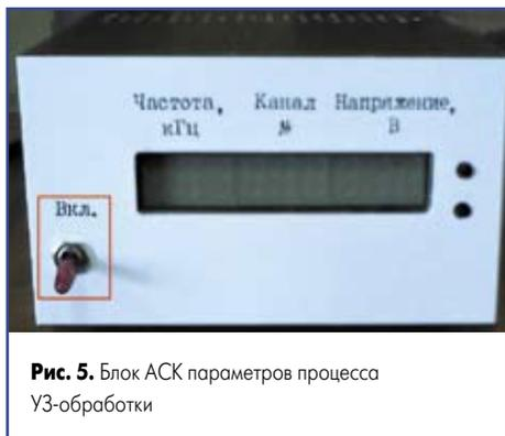
Рис. 5. Блок АСК параметров процесса УЗ-обработки
