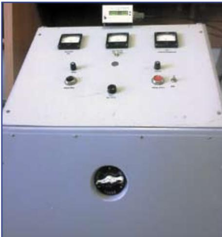
**Рис. 8.** УЗ-генератор с выносным блоком АСК
