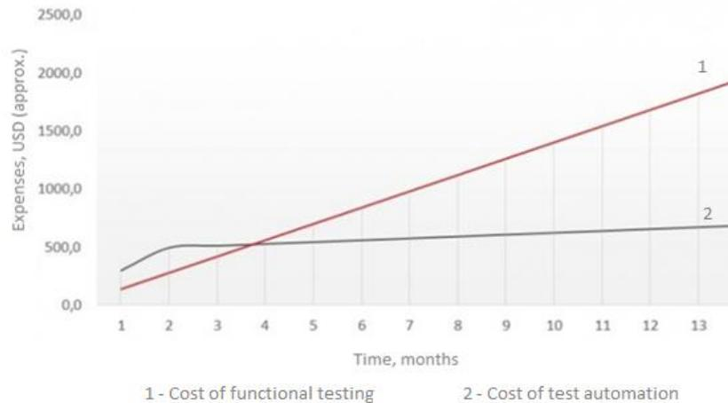
Рис. 3. Соотношение временных и денежных затрат функционального и автоматизированного тестирования
