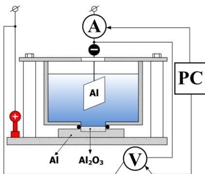
Рисунок 1 - Схема измерения поверхностного потенциала анодных оксидных пленок
