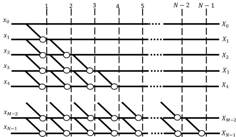
Рис. 1. Граф дискретного преобразования Паскаля
