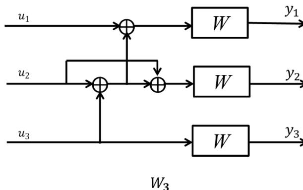
Рис. 3. Структура симметрично канала полярного кода
