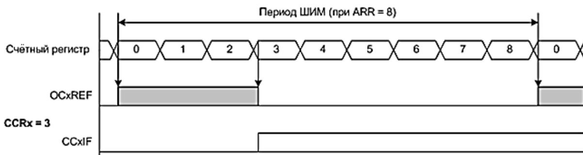
Рисунок 2.7 – Работа ШИМ посредством таймера. Прямой режим
