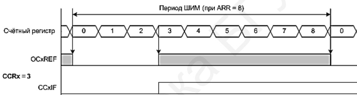
Рисунок 2.8 – Работа ШИМ посредством таймера. Инвертированный режим
