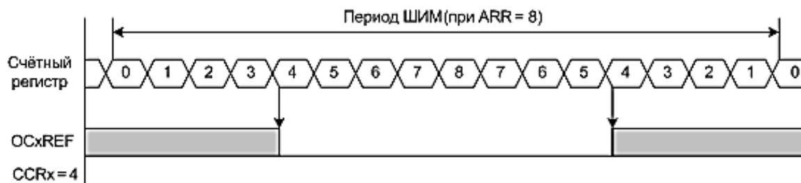
Рисунок 2.9 – Работа ШИМ посредством таймера.
