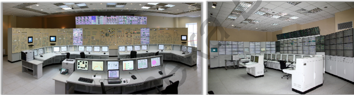
Рис. 4. Полномасштабный имитатор БПУ ПМТ-4 и виртуальный имитатор РПУ/БПУ ПМТ-4
