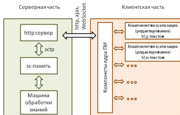
Рисунок 1 – Архитектура программной платформы для реализации web-ориентированных систем основанных на знаниях
