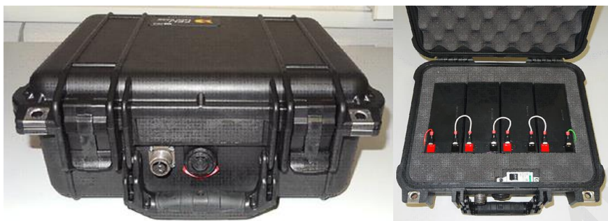
Рис. 63. Внешний вид блока аккумуляторных батарей
