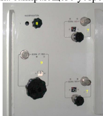
Рис. 46. Нижняя часть передней панели стойки 1500: 7 – ручки перестройки приборов и ВЧ разъемы; 8 – ручка фазовращателя; 9 – окно прибора 1560, ручка перестройки прибора и ВЧ разъем «ВОЛНА 1500»
