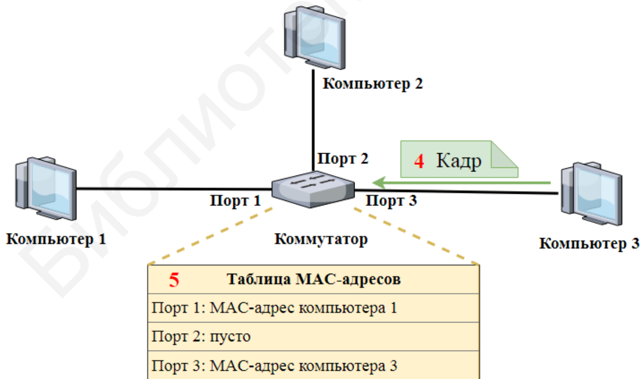
Рисунок 3.2 – Процесс добавления в таблицу MAC-адресов коммутатора адреса назначения
