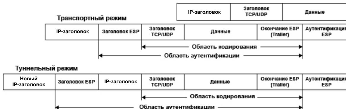
Рисунок 62 – Туннельный и транспортный режим протокола ESP
