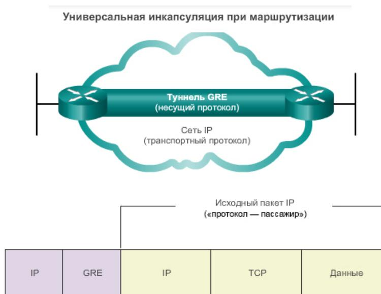
Рисунок 89 – Схема работы GRE-протокола
