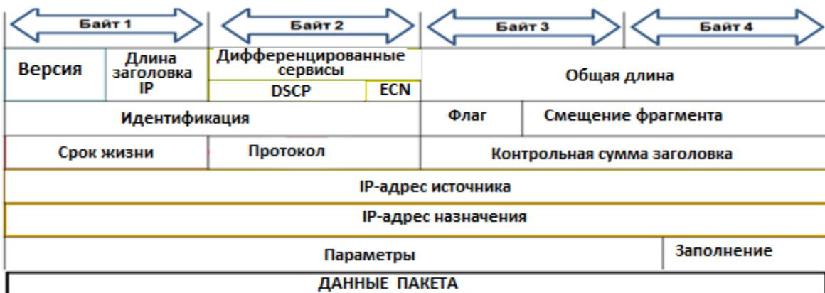
Рисунок 6 – Формат заголовка IPv4-пакета
