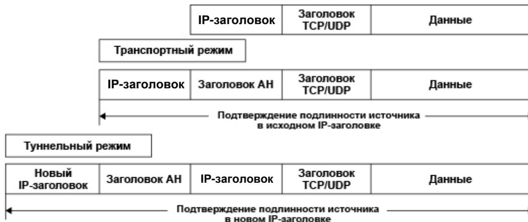
Рисунок 61 – Туннельный и транспортный режимы работы протокола АН
