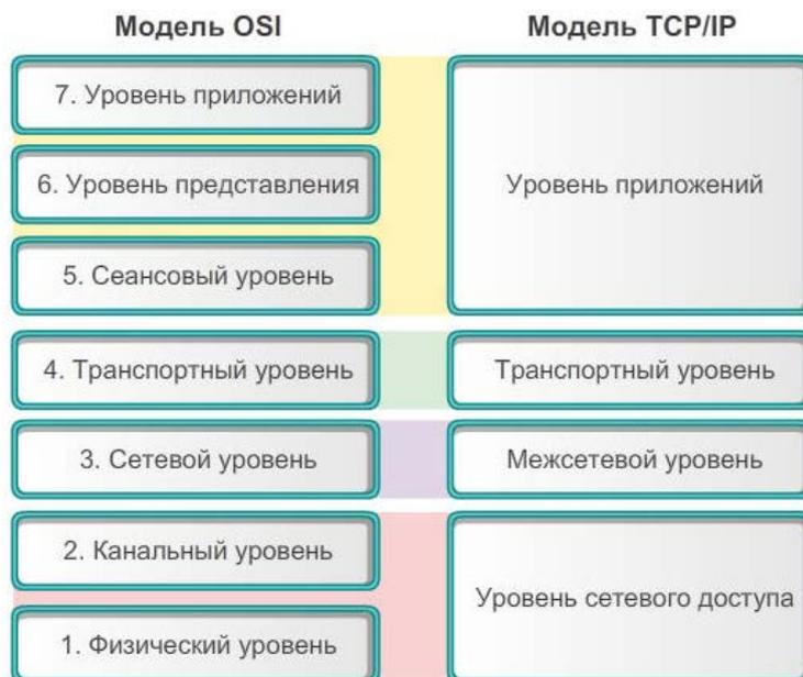
Рисунок 4 – Стек протоколов TCP/IP
