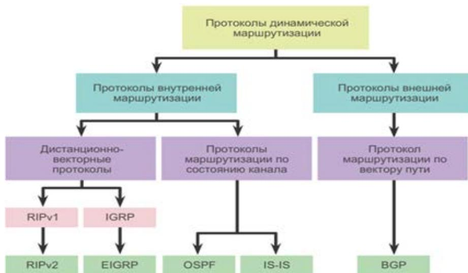
Рисунок 31 – Классификация протоколов динамической маршрутизации
