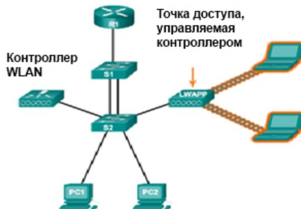
Рисунок 65 – Точки доступа, управляемые контроллером
