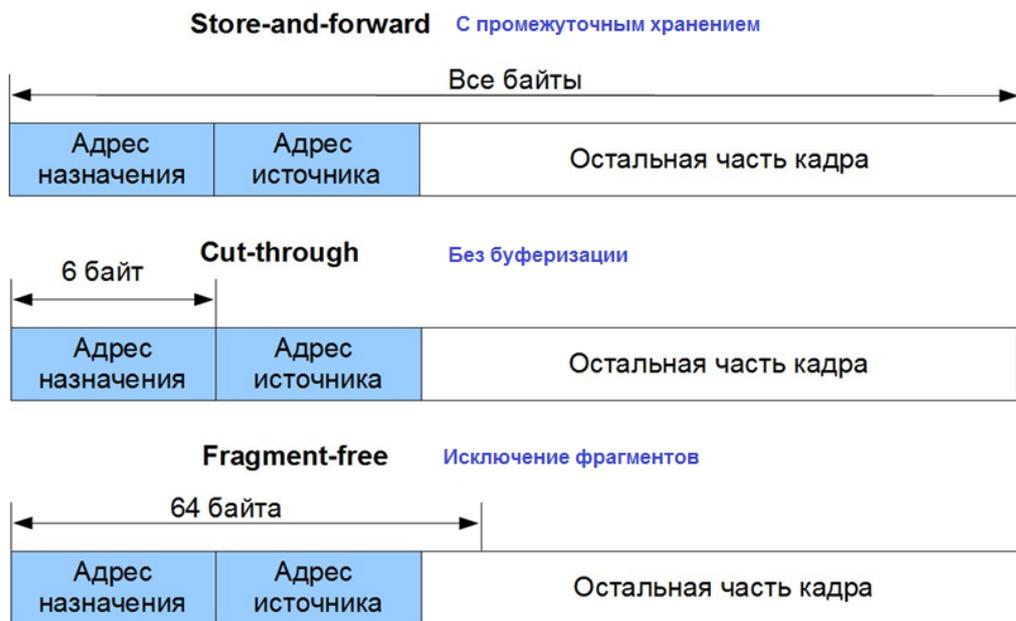
Рисунок 44 – Способы обработки кадров коммутатором
