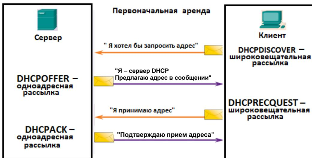
Рисунок 22 – Работа протокола DHCP
