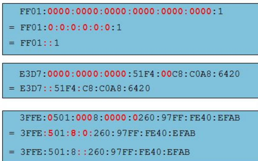
Рисунок 95 – Примеры сокращенной записи IPv6-адресов
