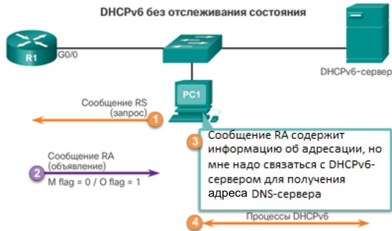
Рисунок 26 – Схема работы протоколов SLAAC и DHCPv6
