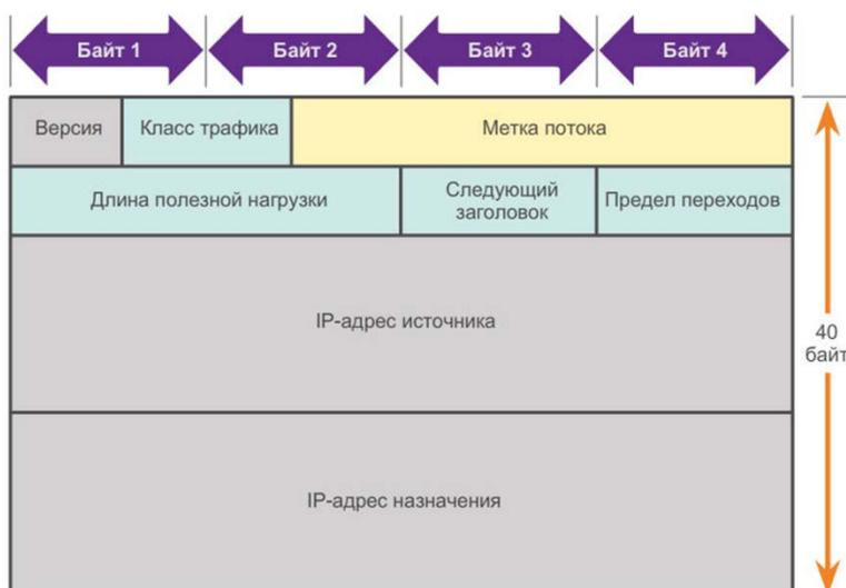
Рисунок 12 – Заголовок IPv6-пакета
