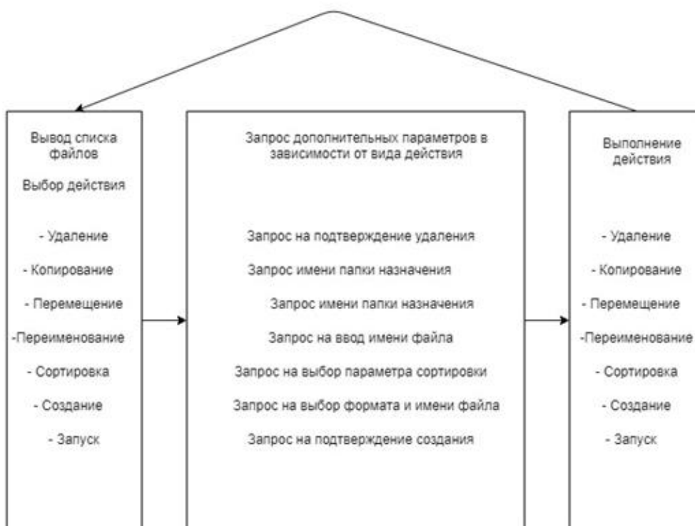
Рисунок 1. Блок-схема файлового менеджера
