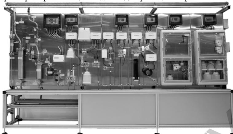
Рис. 1. Общий вид учебно-экспериментального стенда химического контроля
