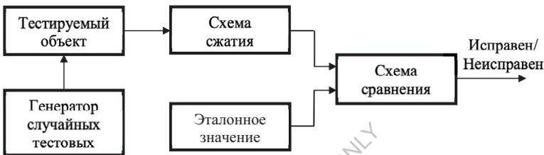
Рисунок 3.2 – Схема вероятностного компактного тестирования
