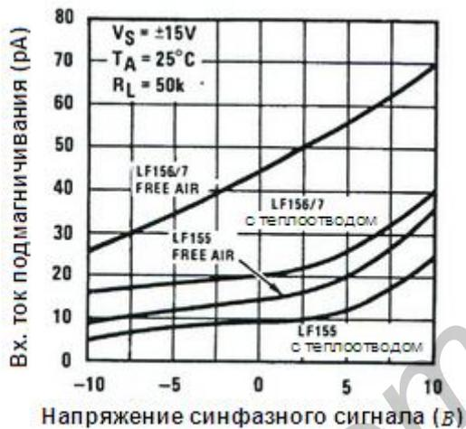
Рис. 3.8. Зависимость входного тока от напряжения синфазного сигнала (LF155)
