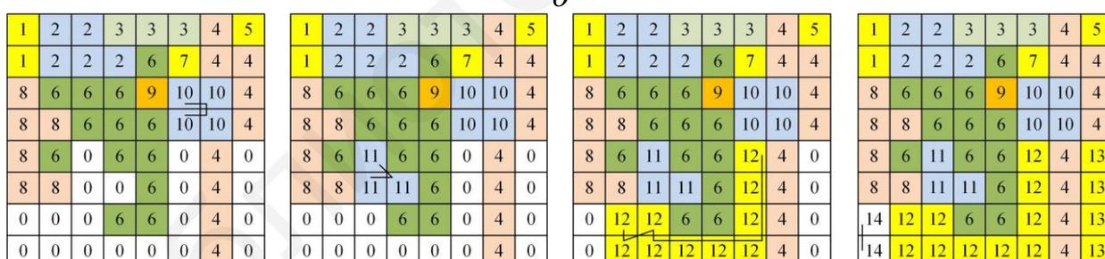
Рис. 3.12. Выделение областей при сравнении значений присоединяемых пикселей с начальным пикселем роста:
