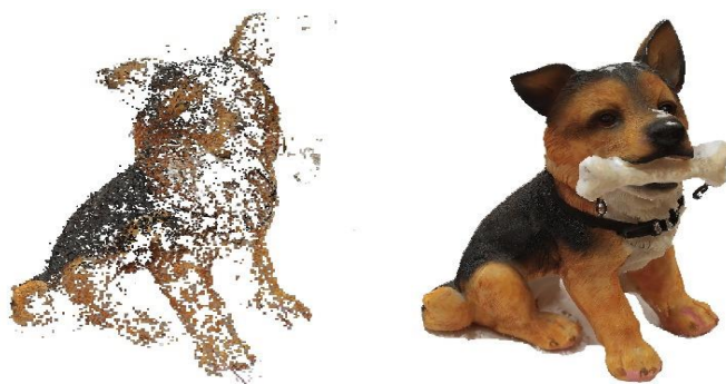
Рисунок 1- Построение облака точек и текстуры модели
