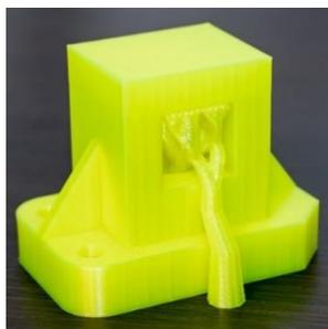
Рисунок 1 – Учебная модель технического изделия, распечатанного на 3D-принтере
