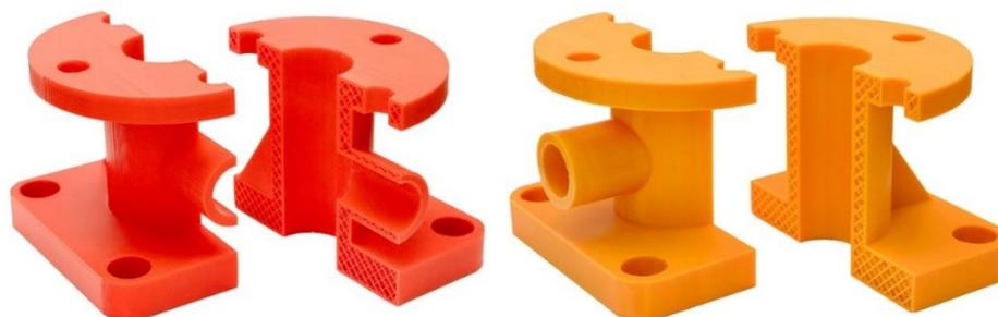
Рисунок 2 – Учебная модель корпуса, распечатанного на 3D-принтере
