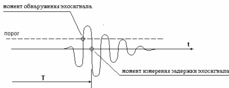
Рисунок 1 – Измерение задержки ультразвукового сигнала методом перехода через ноль [2]
