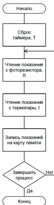
Рисунок 5 – Схема алгоритма работы автоматизированного контроля
