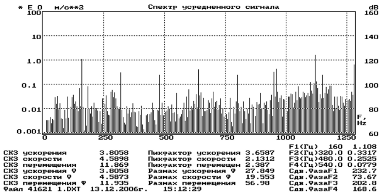
Рисунок 16. Амплитудный спектр вибрационного сигнала ( \text{м/с}^2 ) ДГА для аварийно-опасного режима работы, усредненного во временной области относительно частоты 160 Гц в точке контроля вертикального направления турбины (ось абсцисс – частота, Гц)
