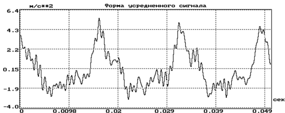
Рисунок 17. Вибрационный сигнал ( \text{м/с}^2 ) в точке контроля вертикального направления турбины ДГА для аварийно-опасного режима работы, усредненный во временной области относительно частоты 62 Гц (ось абсцисс – время в секундах)
