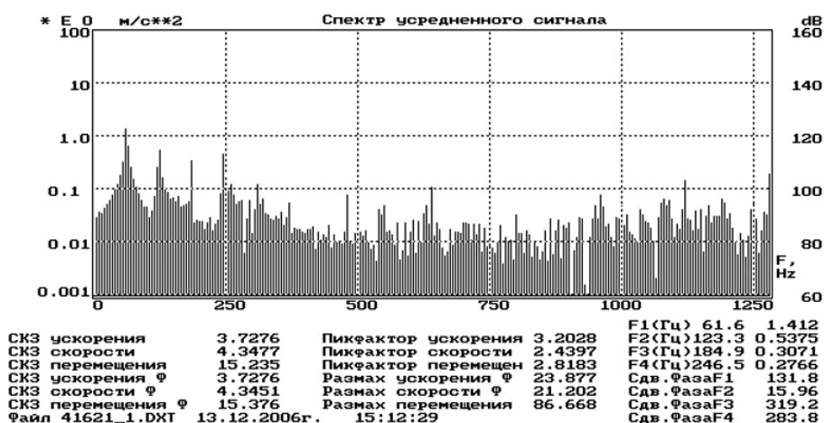
Рисунок 18. Амплитудный спектр вибрационного сигнала ( \text{м/с}^2 ) ДГА для аварийно-опасного режима работы, усредненного во временной области относительно частоты 62 Гц в точке контроля вертикального направления турбины (ось абсцисс – частота, Гц)
