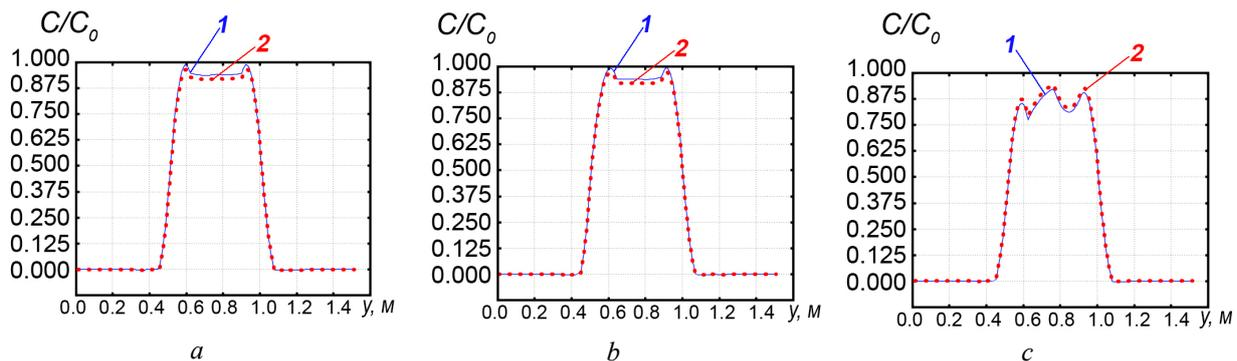
**Рис. 5.** Результаты расчетов распределения концентрации загрязняющего вещества, полученные с помощью ПК COMSOL Multiphysics (кривые 1) и ПК SPS v2.0 (кривые 2) в плоскости ZY:
