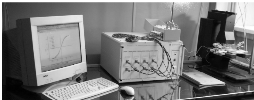
Рис. 2. Измерительный комплекс для определения коэффициента ГМС Fig. 2. Measuring system for determining the GMR coefficient
