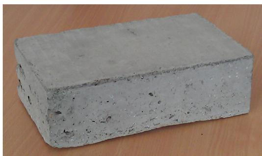
Рис. 3. Внешний вид радиоэкранирующего строительного материала
