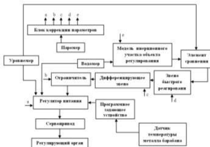
Рис. 2. Схема реализации комбинированной САУ уровнем воды в барабане котла (Патент на изобретение Евразийской патентной организации от 31.08.2017 № 027537 «Регулятор уровня воды в барабане парогенератора»)
