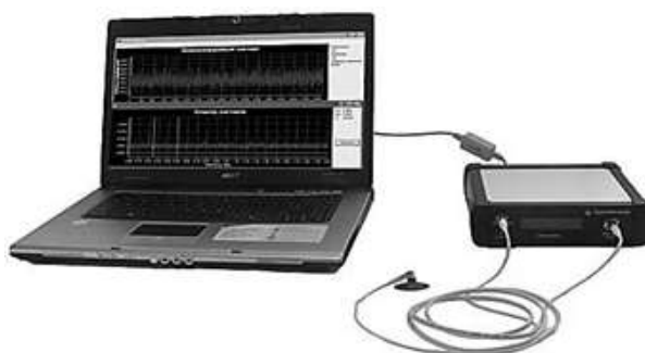
Рис. 1. Устройство Speckle-SCAN для неинвазивной оценки состояния поверхностной микрогемодинамики
