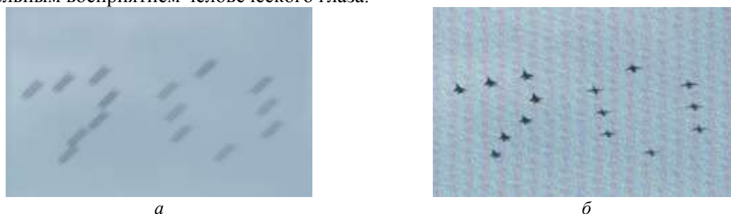
Рис. 4. Пример смазанного изображения (а) и восстановленное изображение методом регуляризации Тихонова (б)
