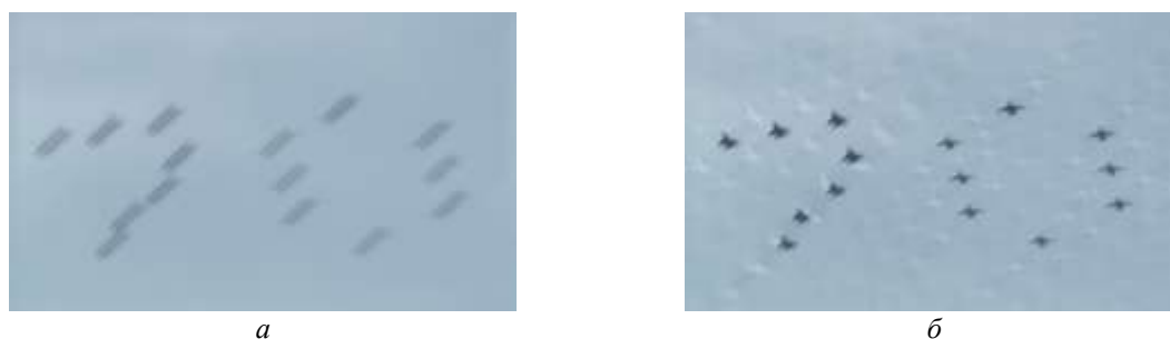
Рис. 3. Пример смазанного изображения (а) и восстановленное изображение методом Винера (б)
