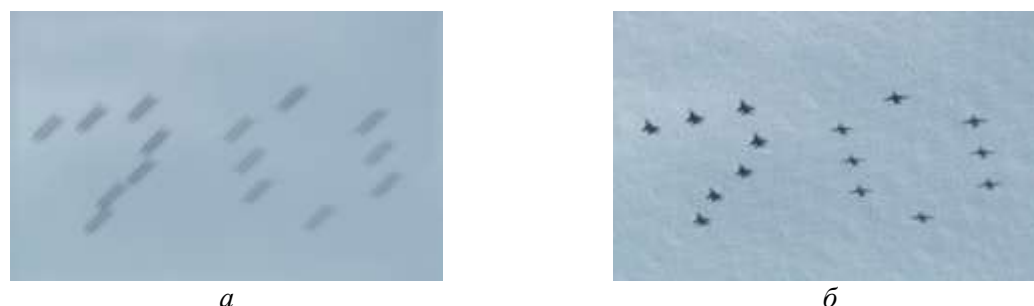
Рис. 6. Пример смазанного изображения ( a ) и восстановленное изображение методом Люси-Ричардсона ( б )
