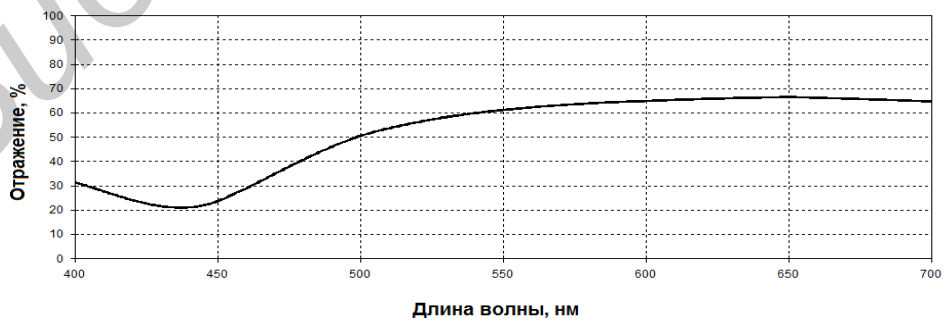
Рис. 5. Спектральная зависимость коэффициента отражения «золотого» покрытия
