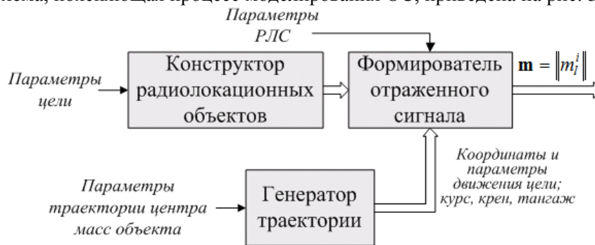
Рис. 2. Обобщенная структурная схема, поясняющая процесс моделирования ОС
