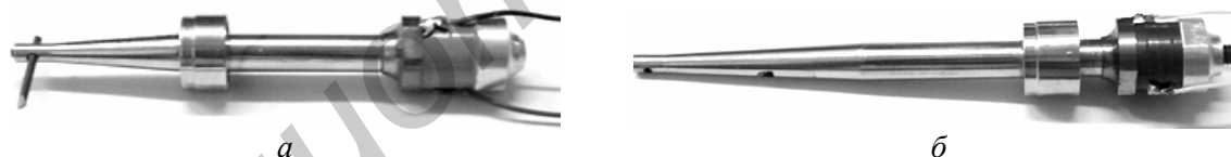
Рис. 3. Ультразвуковые преобразователи стандартной (а) и повышенной частоты (б)
