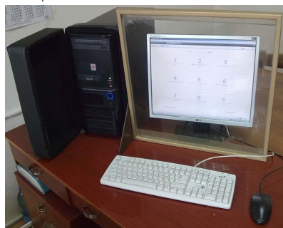
Рис. 5. Внешний вид совместно используемых устройств защиты человека от ЭМИ системного блока и дисплея персональных компьютеров
