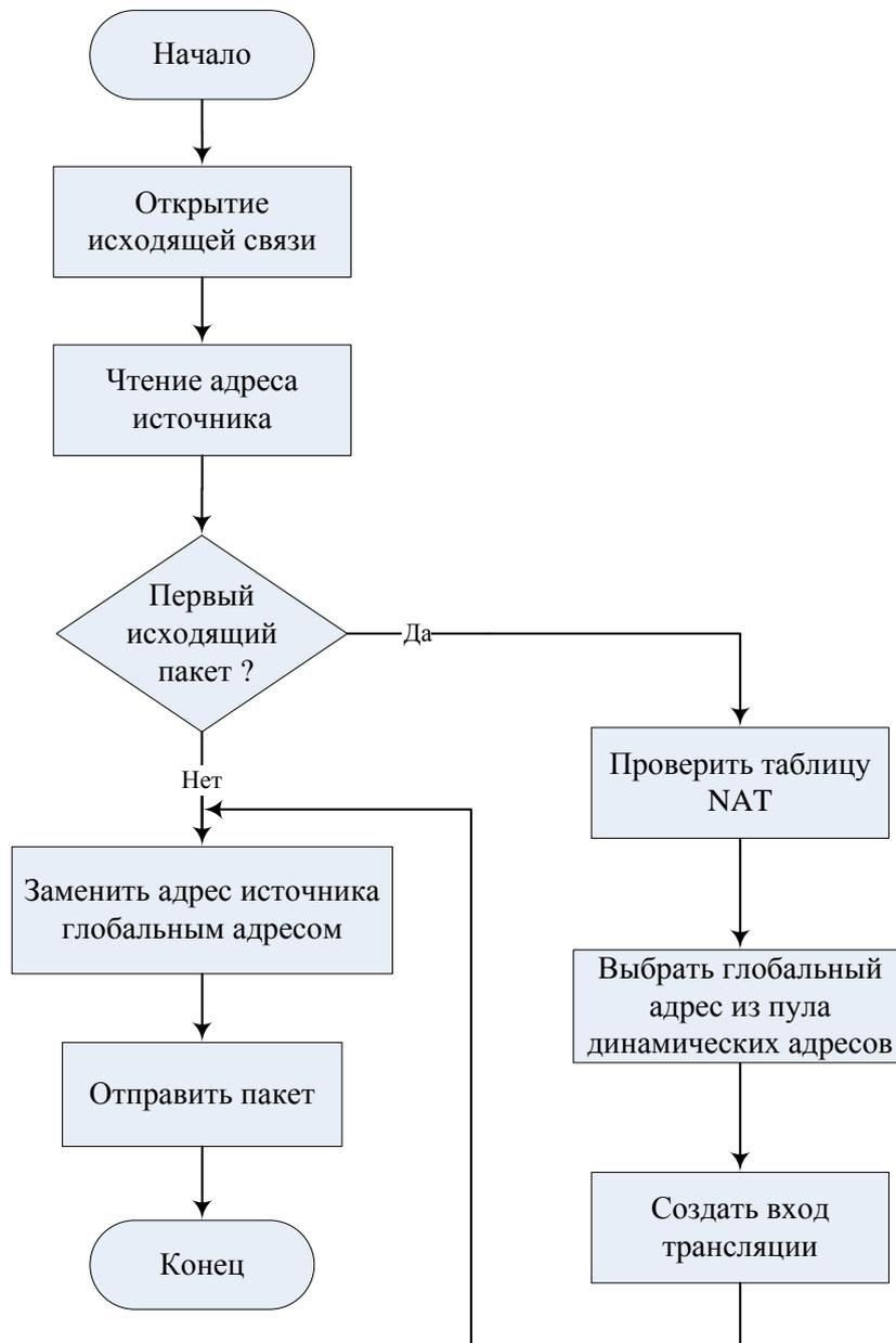
Рис. 3. Алгоритм трансляции внутреннего адреса источника динамическим методом
