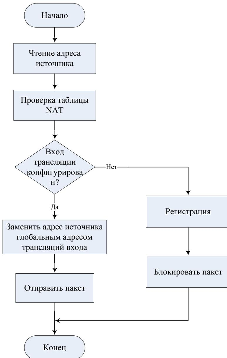
Рис. 2. Алгоритм трансляции внутреннего адреса источника статическим методом
