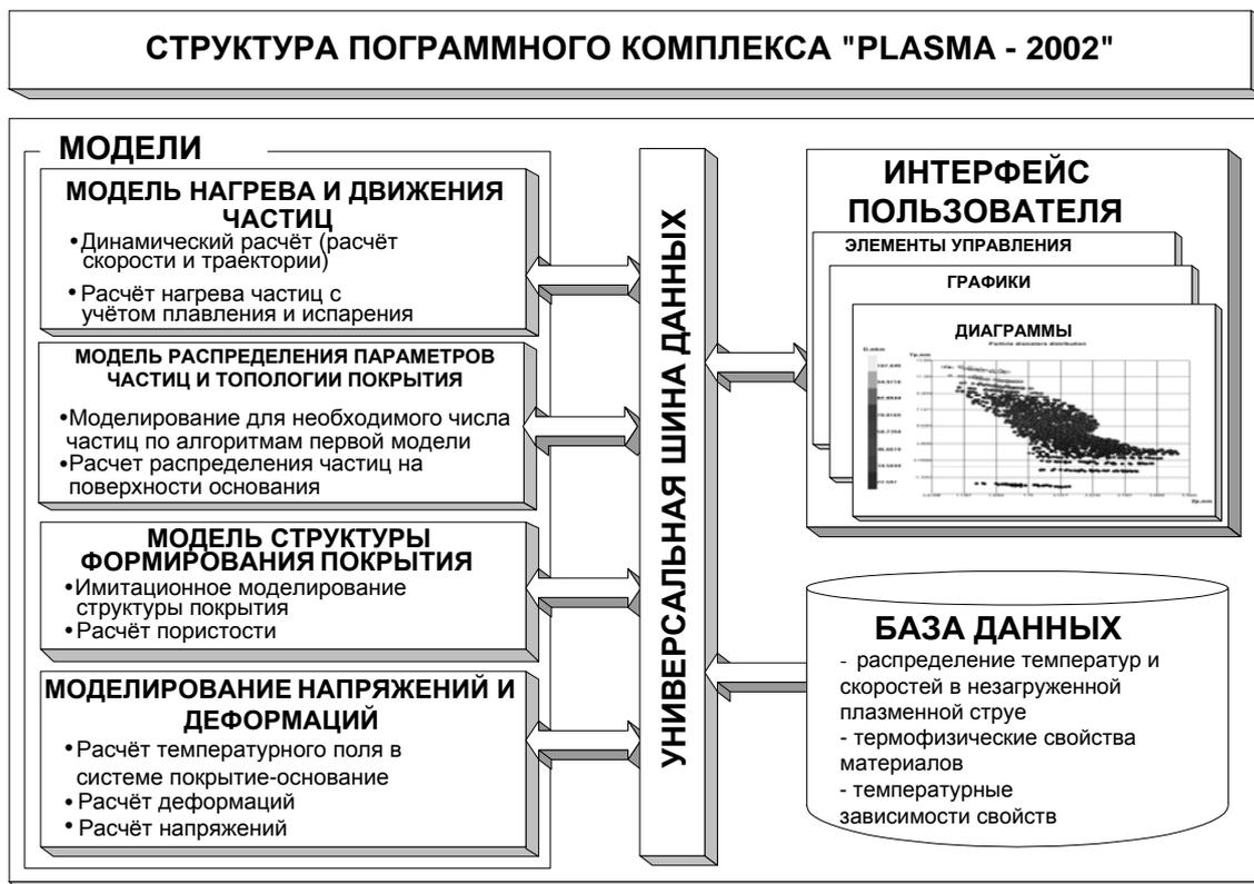
Рис. 3. Структурная схема программного комплекса Plasma
