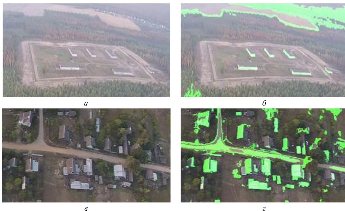
Рис. 1. Детектирование антропогенных объектов на основе системы геометрических признаков: а, в – исходные аэроизображения; б, г – выделенные антропогенные объекты
