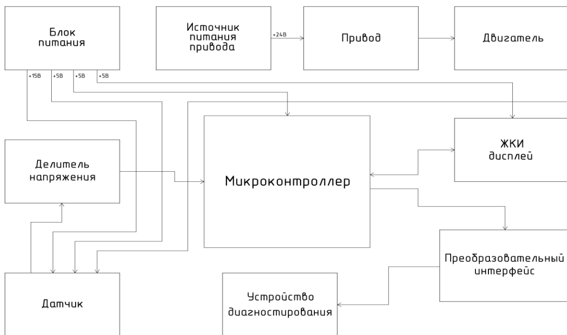
Рисунок 1 – Структурная схема системы диагностирования
