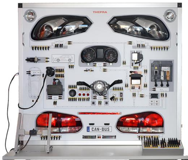
Рисунок 2 Учебный макет – тренажер, CAN-Bus [2]
