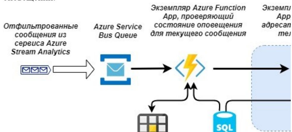
Рисунок 5. Реализация логики рабочего процесса подсистемы рассылки оповещений, созданной на основе сервиса Azure Logic App.
