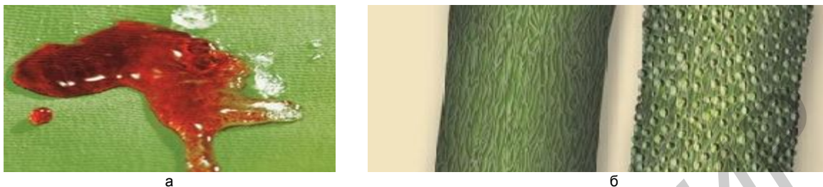
Рис. 3 – Ткань, которая "сбрасывает" воду и другие пищевые жидкости: а – свойство сверхгидрофобности, б – необработанное хлопковое волокно (слева), обработанное хлопковое волокно (справа)
