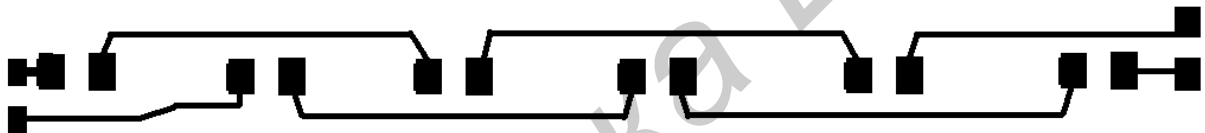
Рисунок 2 – Вид на матрицу 6 сверхярких светодиодов на основании из алюминия с нанопористым анодным оксидом.
