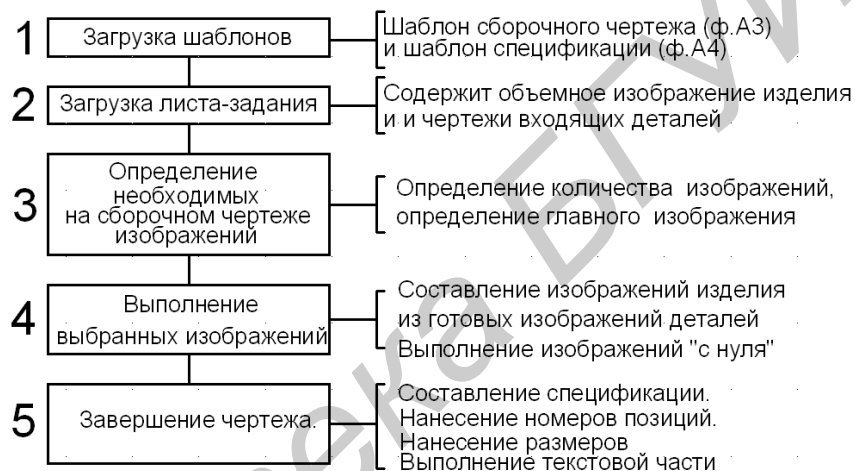
Рис. 1. Этапы выполнения электронного сборочного чертежа
