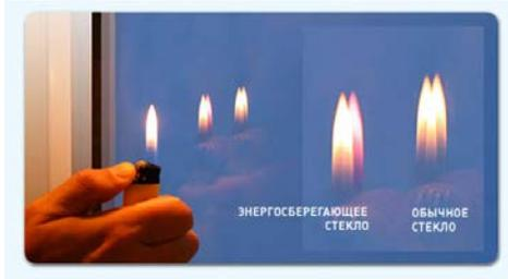
Рис. 3 – отражение огонька в обычном и энергосберегающем стеклах
