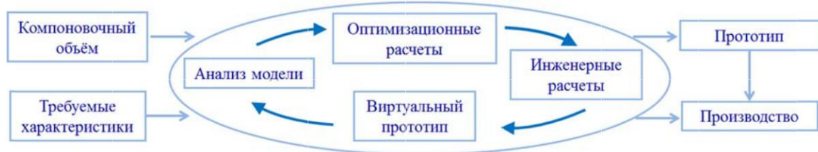
Рисунок 4 – Подход к проектированию на основе оптимизации
