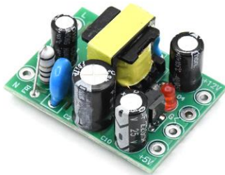
Рисунок 3 – Конвертер переменного тока в постоянный
