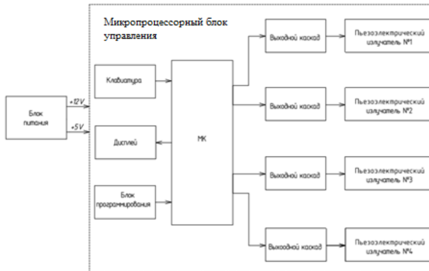
Рисунок 1 – Структурная электрическая схема ультразвукового косметологического аппарата
