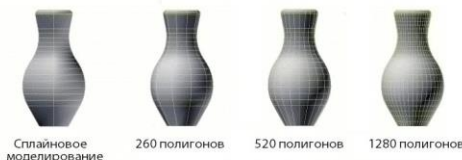
Рисунок 3 – Сравнение сплайновой и полигональной графики
