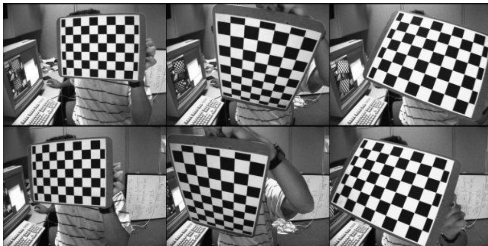
Рисунок 2. – Ручная калибровка камеры
