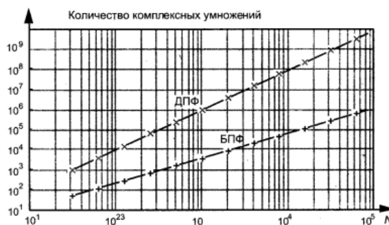
Рисунок 1 – Количество комплексных умножений, как функция N , при реализации ДПФ и БПФ
