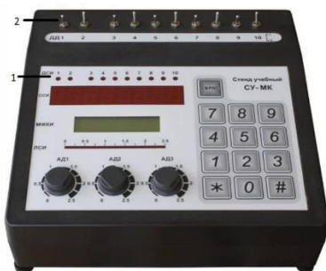
Рисунок 1 – Стенд НТЦ-31.100 с указанными ДД и ДСИ
