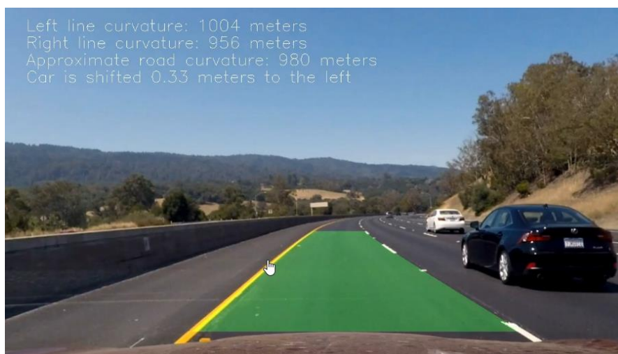
Рисунок 3 – Результат аннотирования изображения данными о локализации автомобиля
