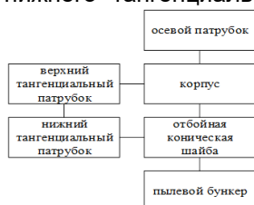
Рисунок 1 – Схема пылеуловителя ВЗП
