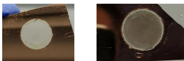
Рисунок 3 – Образцы стекла с медной плёнкой после её локального анодирования в растворах 0,3 % (слева) и 1,5 % (справа)
