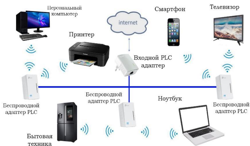
Рисунок 1 – Схема реализации технологии PLC
