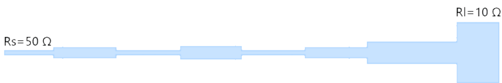
Рисунок 3 – Структура 2 топологии ступенчатого трансформирующего фильтра диапазона СВЧ
