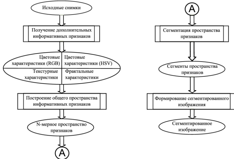
Рис. 4. Схема алгоритма сегментации с использованием дополнительных признаков
